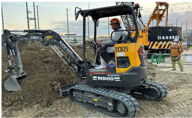
バッテリー駆動式コンパクトショベル「ECR25」、重量 2.7t、バケット容量 0.12 m 3
